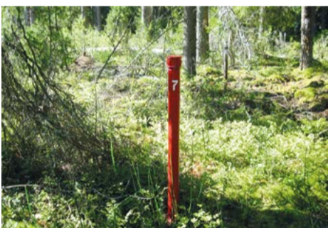
Смотровые колодцы для наблюдения за уровнем грунтовых вод
